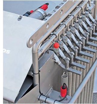
高强度弹簧提供 网口开闭的动力
